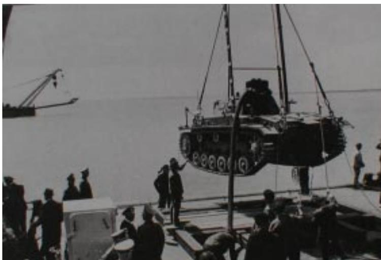
La foto muestra un Panzer III durante unas pruebas, equipado con el equipo de vadeo profundo colocado en el compartimiento del motor (aunque una variante lo tenía directamente en la cúpula del comandante). Las dos barras verticales son testigos para medir la profundidad a la que estaba sumergido el tanque.
