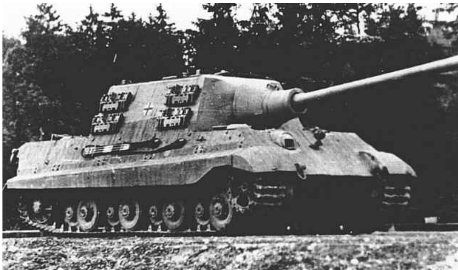
Jagdtiger suspensión Porsche. Estos modelos solían ir recubiertos de pasta Zimmerit.
