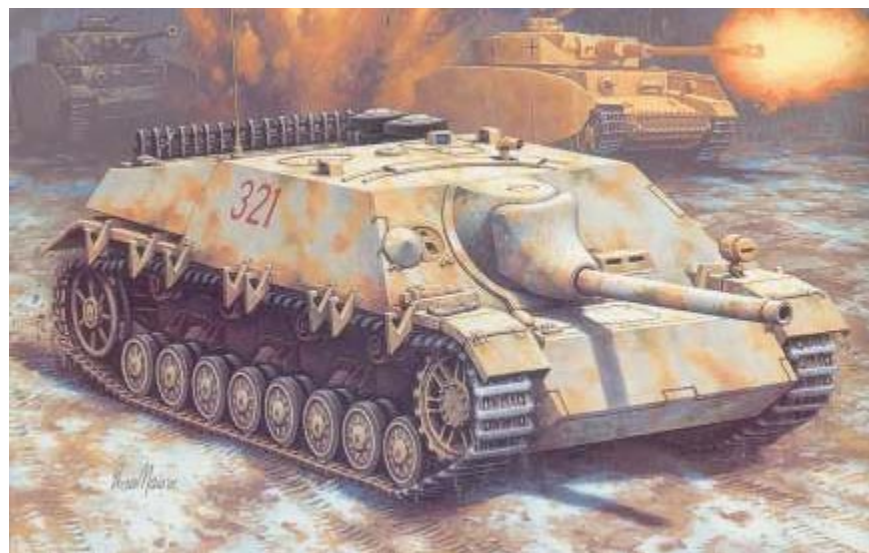
Visión artística de un Jagdpanzer IV en combate junto a dos Panzer IV. Obsérvense los enganches dispuestos para la colocación de Schürzten.
