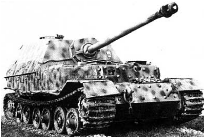
El Elefant. Puede apreciarse la MG 34 situada a la derecha del glacis y el recubrimiento de zimmerit. La cúpula del comandante es también visible.
