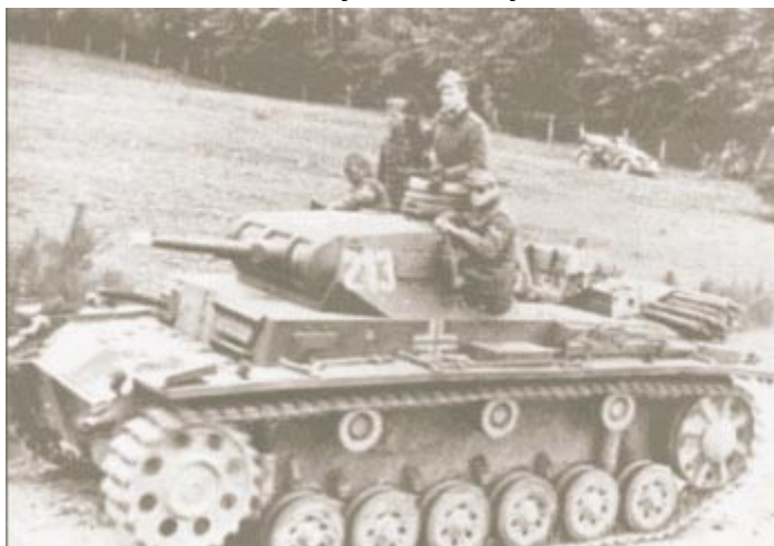
Panzer III ausf E armado con el cañón de 3.7cm KwK L/46.5
