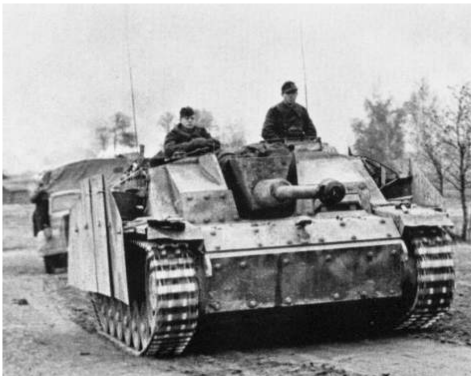
Stug III ausf G en Rusia. Obsérvese el bajo perfil del vehículo con el cañón montado casi al nivel del conductor.
