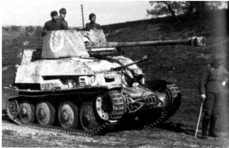
Marder III für 7,62cm PaK 36(r), nótese la escasa protección que brinda la superestructura, sobresaliendo el torso de la tripulación cuando ésta va de pie.
