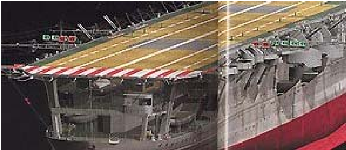
En este dibujo del Shokaku se puede observar el sistema de luces de ayuda al aterrizaje que se montaron en el Soryu.
