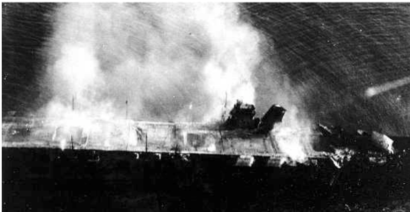
El portaaviones Hiryu ardiendo a la mañana del 5 de Junio de 1942, poco antes de su hundimiento. La plancha retorcida delante de la isla corresponde al elevador delantero sacado de su pozo por la explosión de las bombas que lo alcanzaron.
